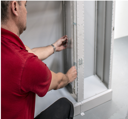
Sidestykker monteres med skrue i begge sider. Inderste top/bund monteres
