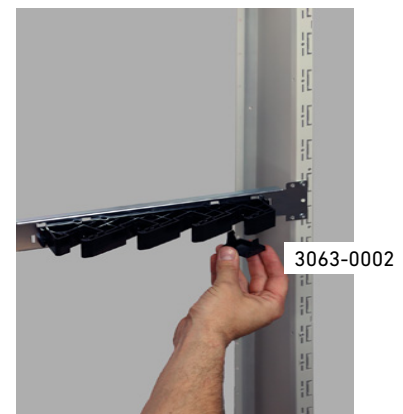
Skinneholder klikkes fast enten vandret eller lodret, stopbrikker monteres i bund af søjle.
