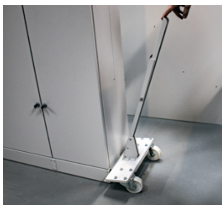
Brug transporthjul til at hæve tavlen fra gulv
